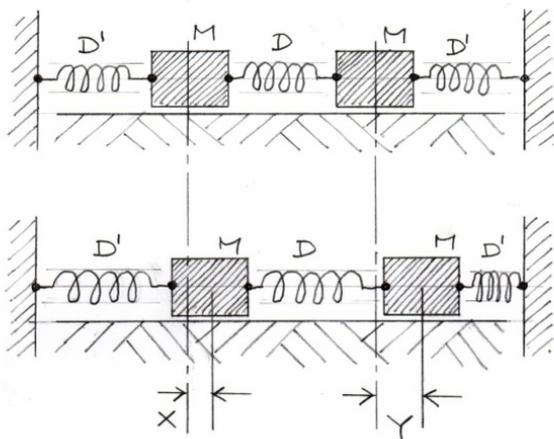
Abbildung 1 Zwei gekoppelte Pendel, z. B. Gleiter auf einer Luftkissenbahn, die durch eine Spiralfeder (Federkonstante  $D$ ) gekoppelt sind und außen von zwei weiteren Federn (Federkonstante  $D'$ ) gehalten werden. Oben: Ruhelage, unten: beide Federn ausgelenkt
