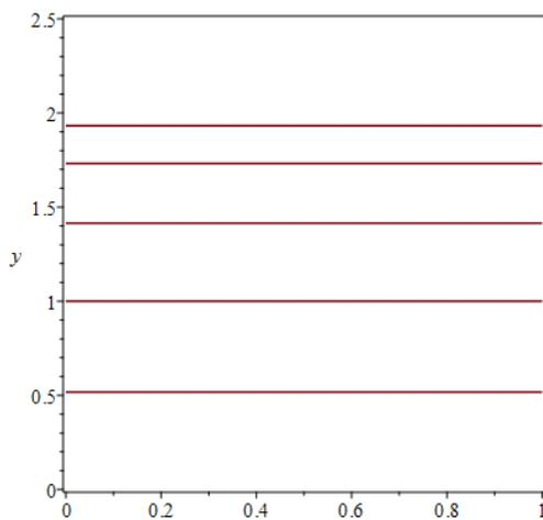
Abbildung 4 Spektrum der Eigenfrequenzen einer Kette aus 5 gleichen Massen
